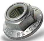
**Selbstsichernde Mutter mit elastisch verformbarem Nyloneinsatz** garantiert mit dieser Art der Losdrehicherung das vorgegebene Drehmoment, sodass die Vorspannung erhalten bleibt. Der angebrachte Warnhinweis zeigt die Einmalverwendung dieser Mutter an.
